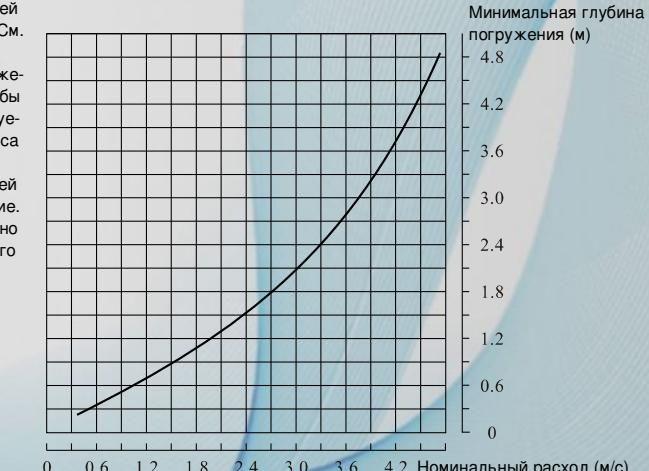
$$\text{Номинальный расход (м/с)} = \frac{\text{Расход (м/ч)}}{\text{Площадь сечения трубы (м}^2\text{)}}$$
