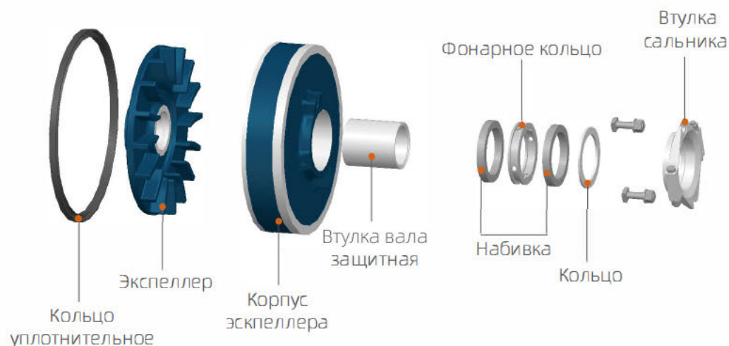
Рисунок 1: Сборка экспеллерного уплотнения
